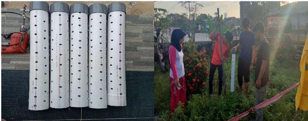
**Gambar 4** : (A)Bentuk Biopori yang sudah jadi dan (B)Proses Penggalian Tanah untuk Pemasangan Biopori
