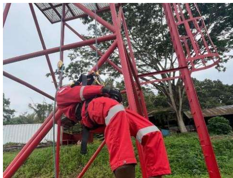
Gambar 3. Simulasi korban tergantung pada sistem penahan jatuh
