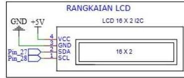
Gambar 4. Rangkaian LCD dengan Modul I2C
