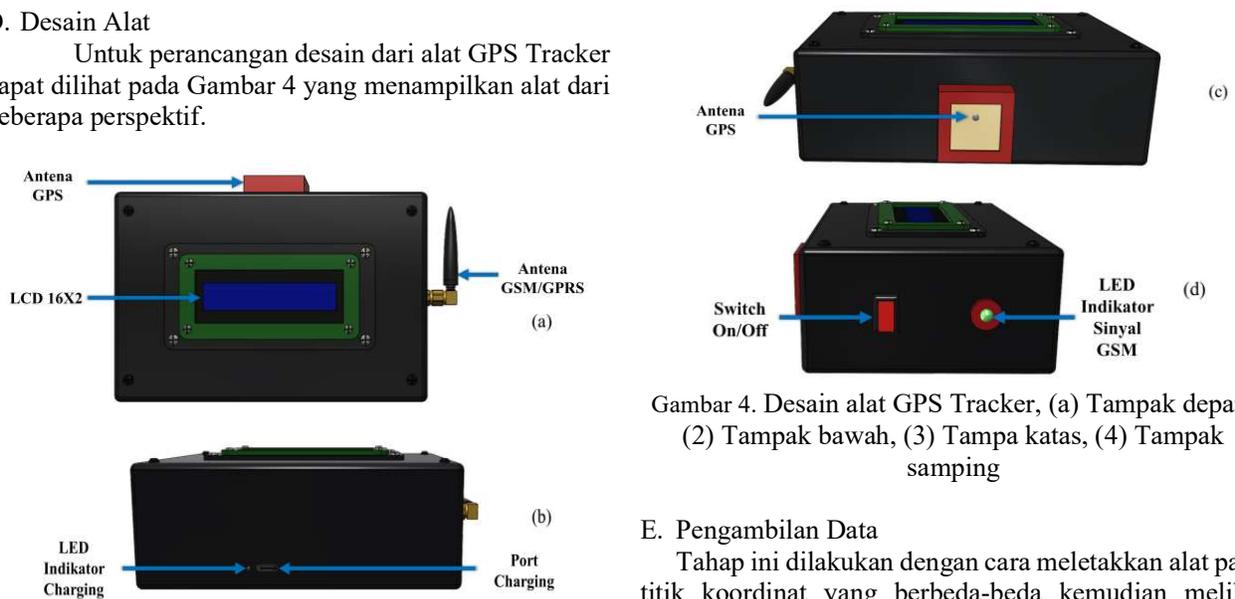
Gambar 4. Desain alat GPS Tracker, (a) Tampak depan, (2) Tampak bawah, (3) Tampak atas, (4) Tampak samping
